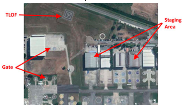
Figure 2 - Aeroporto Campo de Marte exibindo atributos de uma topologia de “Pátio Remoto” (Vascik & Hansman, 2019).
